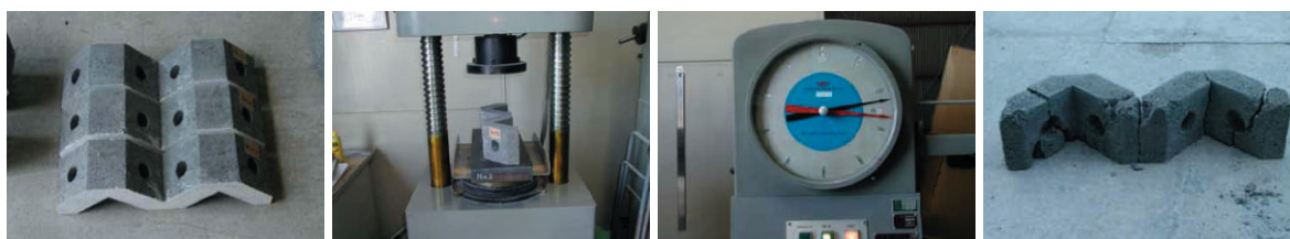
マンホール商会茨城工場での曲げ・圧縮試験（18.7.26）
