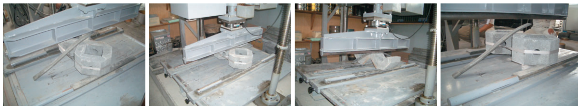
アゲオ・試験室でのWブロック曲げ・圧縮試験（18.7.17）
